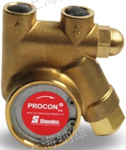
全新供应PROCON循环水泵2503高压旋转叶片泵，美国PROCON2503叶片泵，美国原装进口，上海纳维环保设备有限公司专业提供PROCON叶片泵，大量现货，上海库存，一台起售。本公司郑重承诺，所有产品均为PROCON原厂生产|PROCON2503叶片泵为黄铜叶片泵，流量140加仑/小时（400升/小时），压力250PSI（约17公斤），扬程140-170米，内置安全阀，卡扣/法兰连接，节能环保，可用于纯水机、水刀切割机|TIG焊接冷却系统、反渗透系统、冷循环、恒温控制系统、洗车系统、蒸汽清洗机、水净化、锅炉给水等，具有耐磨、不阻塞、卫生、低噪音、使用寿命长等优点。陕西PROCON卧式冷却循环水泵哪里有上海纳维环保设备有限公司为您提供冷却循环水泵，有想法的可以来电咨询！
